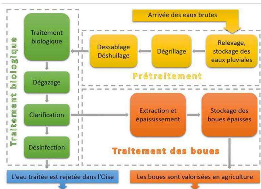
L'eau brute (eaux pluviales\*, lessive, urine, excréments) arrive à la station par un tuyau de 30 centimètres de diamètre dans une zone de stockage où elle subit un pré dégrillage afin d'enlever les gros déchets (bout de bois, canettes...) puis un dégrillage pour supprimer les petits déchets à savoir les lingettes, cotons... Ensuite ce sont le sable et les graisses qui sont retirés pour être dirigés vers un centre spécialisé.
